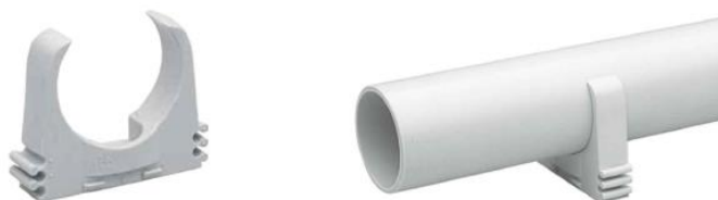
DETTAGLIO FISSAGGIO CAVIDOTTI INTEGRATI CLIP PER TUBO RIGIDO IN PVC PRIVO DI ALLOGENI, SERIE PESANTE, NON PROPAGANTE LA FIAMMA, NON EMANANTE GAS TOSSICI, CON RESISTENZA ALLO SCHIACCIAMENTO 750 NEWTON, DEL DIAMETRO DI: 25 MM.
