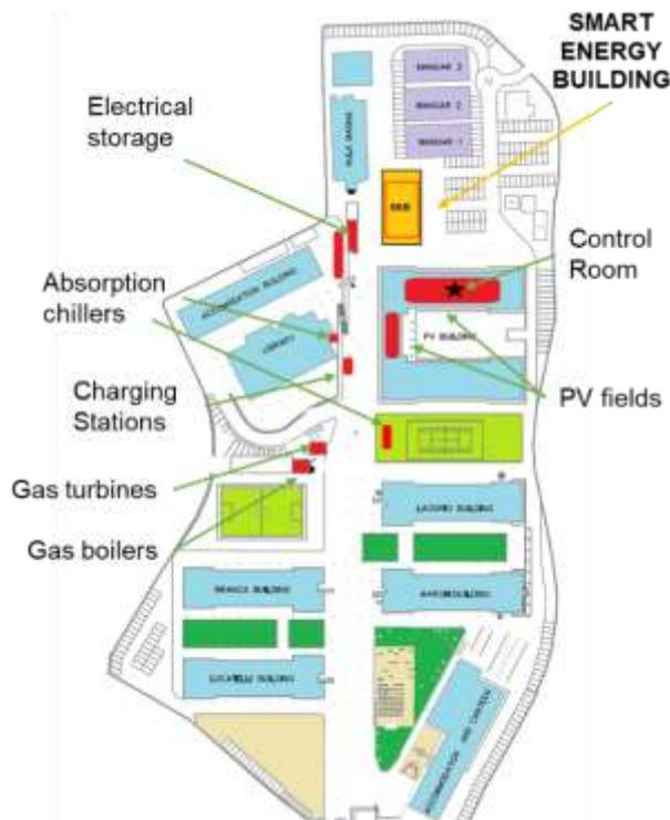
Figura 1. Planimetria del Campus con ubicazione degli edifici, dei dispositivi principali della SPM ed il SEB, delle Unità di generazione ed altri dispositivi
